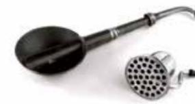
図1 トランペット型聴音器の例
