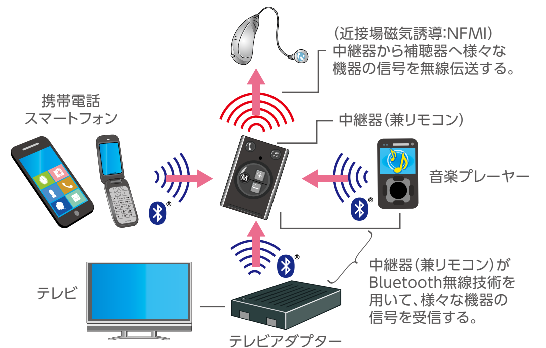
図14 中継器を介して様々な機器の音信号を無線受信
